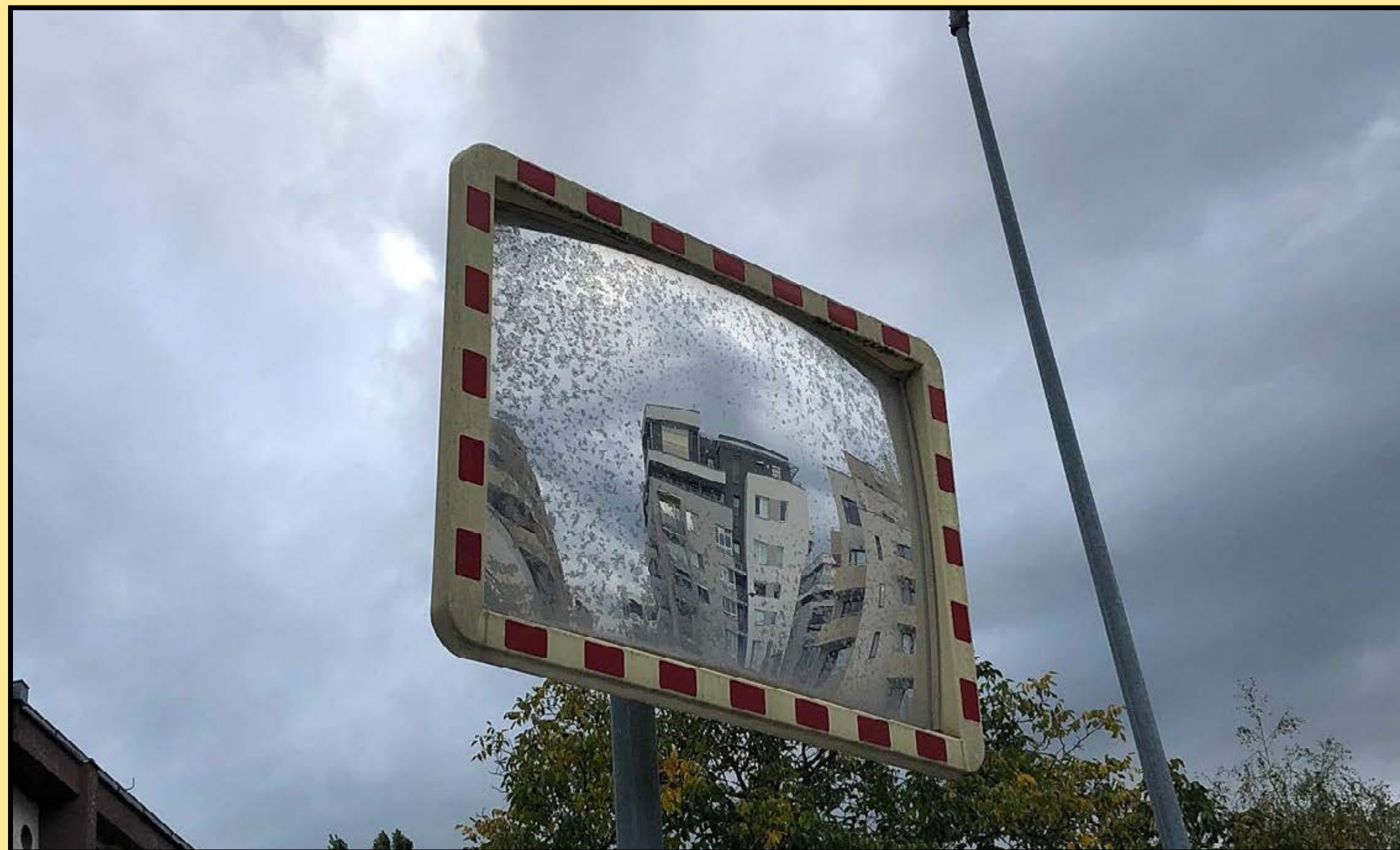
Poškozené dopravné zrkadlo
